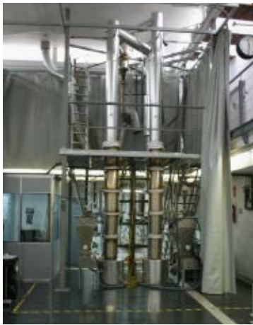
Figura 3. izq) Planta experimental 30 kWt de lechos fluidizados circulantes, INCAR; dcha) Ejemplo de resultados experimentales en el que se muestran eficacias de captura elevadas.
