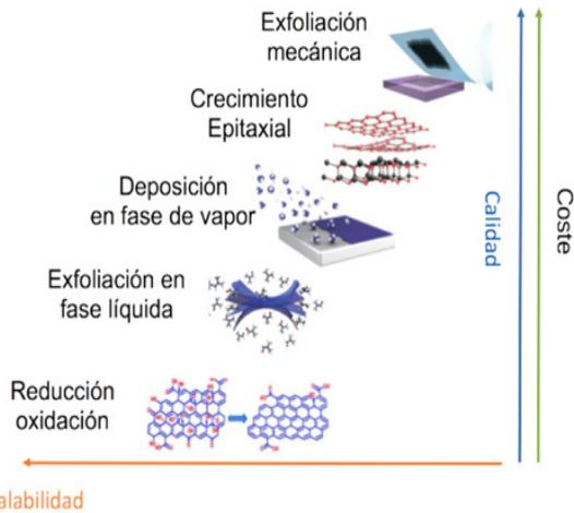
Figura 5. Métodos de obtención de grafeno.
