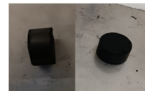
Figure 1. Monolito antes y después del test de impacto.
