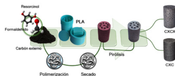
Figura 1. Proceso de elaboración de monolitos de xerogel de carbono.
