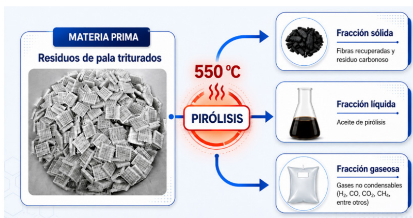
Figura 2. Productos obtenidos en la pirólisis de residuos de palas de aerogenerador y sus posibles rutas de valorización.
