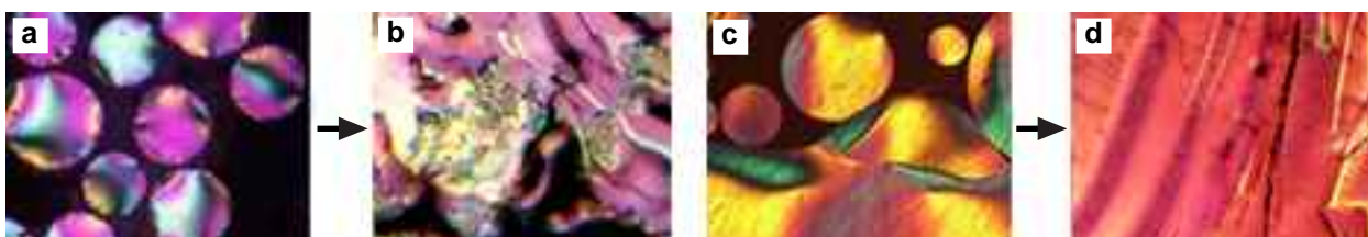
Figura 9. Mesofase/coques procedentes de (a/b) brea de alquitrán de hulla y (c/d) brea de petróleo.
