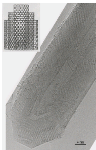
Figura 10. Imagen TEM y modelo estructural de un nanotubo de carbono de multipared. Adaptado de la Ref. 27.
