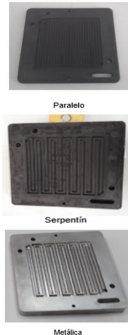
**Figura 10.** Geometrías de placas usadas en los ensayos.
