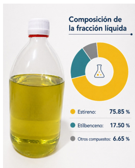
Figura 7. Principales componentes de la fracción obtenida en la destilación en reflujo 6:1.
