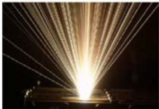
Figura 5. Test de alto flujo de calor ( 2.43 \text{ GW/m}^2 ) en grafito y el mismo grafito dopado con Zr. Figure 5. High heat flux test ( 2.43 \text{ GW/m}^2 ) on graphite and Zr-doped graphite.
