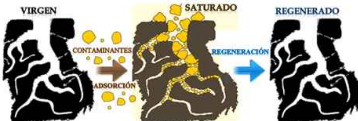
Figura 2. Esquema del proceso de saturación de un CA, durante el tratamiento de un efluente con contaminantes, y su posterior regeneración.
