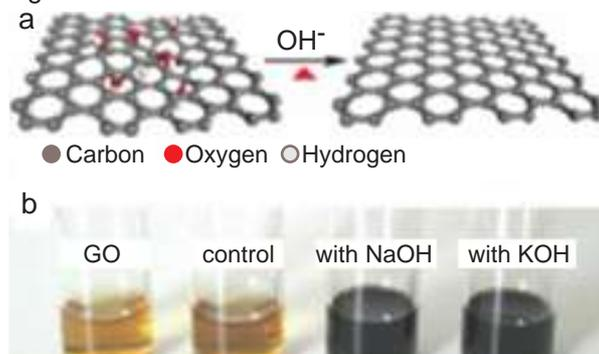
**Figura 1.** (a) Ilustración del proceso de desoxigenación de óxido de grafeno en medio fuertemente alcalino. (b) Fotografías digitales de: una dispersión de óxido de grafeno prístino (GO), la misma sometida a tratamiento térmico a 90° C durante 5 horas (control), reducida con NaOH con el tratamiento previo, y con KOH (en lugar de NaOH). Adaptado de la ref. 26.
