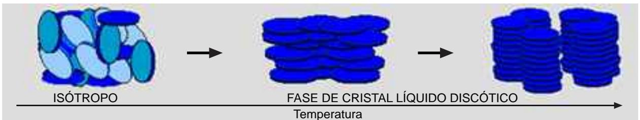
Figura 6. Asociación molecular y apilamiento de mesógenos.
