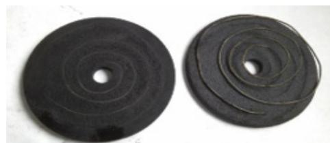
Figura 2. Electrodos de grafito. Figure 2. Graphite electrodes.
