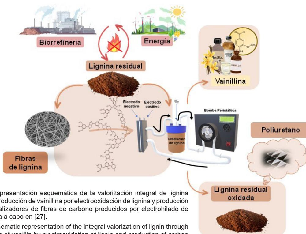
**Figura 4.** Representación esquemática de la valorización integral de lignina mediante la producción de vainillina por electrooxidación de lignina y producción de electrocatalizadores de fibras de carbono producidos por electrohilado de lignina llevada a cabo en [27].
