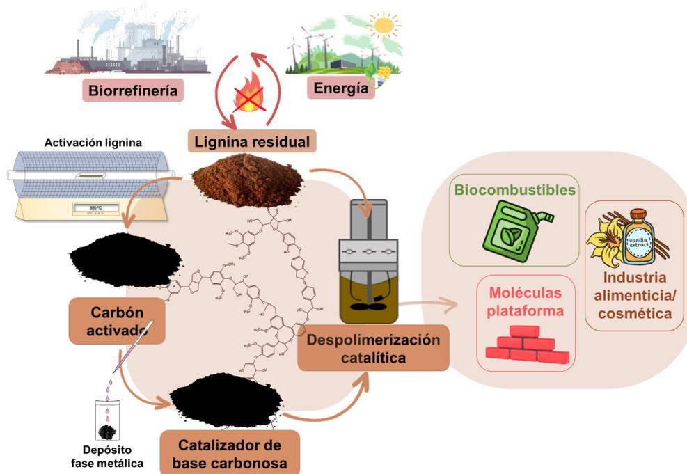
**Figura 5.** Representación esquemática de la valorización integral de lignina mediante su despolimerización catalítica sobre catalizadores producidos de base carbonosa producidas a partir de su activación.
