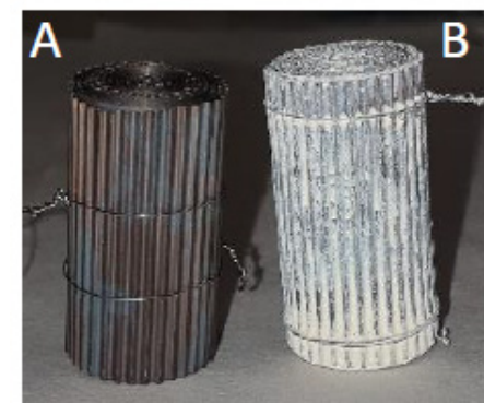
Figura 1. Aspecto del micromonolito sin (A) y con (B) catalizador.
